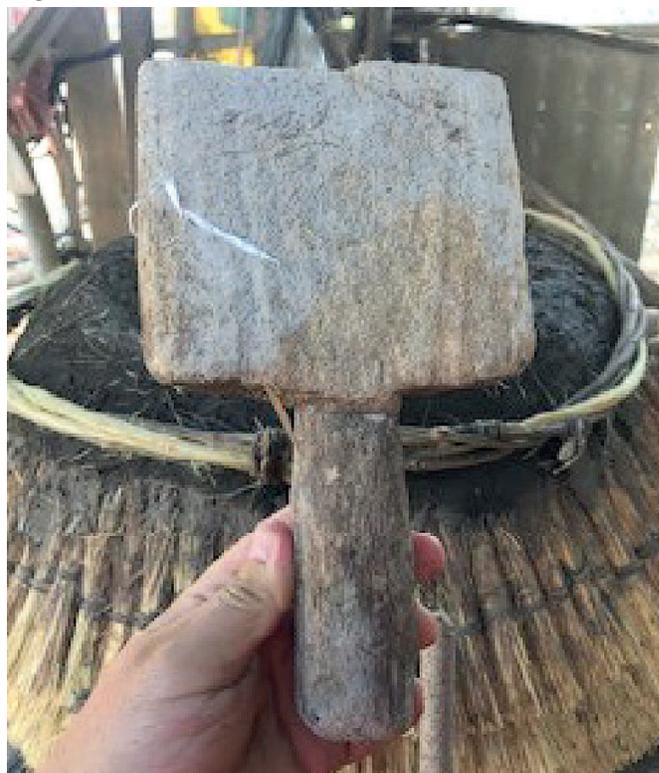
Con el Pitito Figura 21, el constructor finalmente le otorga el acabado característico de los alerones de las capas de zacate superpuestas, a manera de liana, alinea las capas de zacate de abajo hacia arriba, peinando el zacate a placer, es con esta herramienta que genera el acabado final de la techumbre tan característico.
