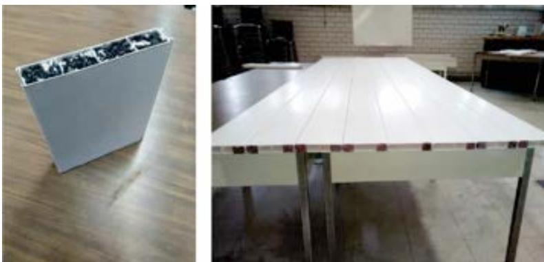
*Nota:* La figura muestra las diferentes configuraciones de la tableta de PVC siendo rellena con *pellets* de polietileno (fotografía izquierda) y postes de PVC reciclado (fotografía derecha).
