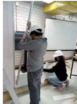
*Nota:* La figura muestra cómo se recubrieron las cajas para aislar el sonido y tomar las mediciones correspondientes al colocar los paneles de PVC entre las cajas.
